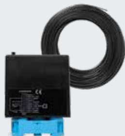
Indukčná slučka Detektor so zatváracím kontaktom a meničom, nastaviteľný na impulzový alebo trvalý kontakt, s rozpoznávaním smeru, slučkový kábel 50 m
